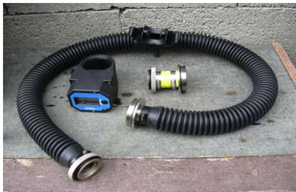
Les classiques : Tuyau annelé, embout, et sonde oxygène (ici un Oxy 2 de Uwatec)
